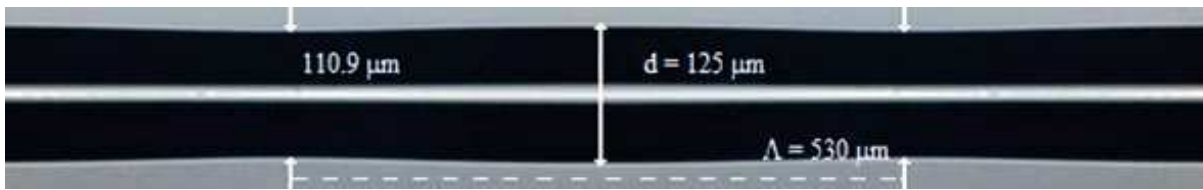
Figura 35 – Microfotografia da LPG produzida com modulação ponto a ponto
