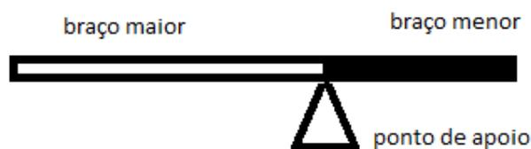
Figura 1: Modelo de alavanca interfixa
