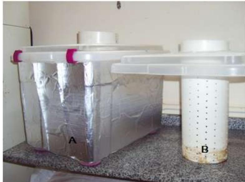
**Figura 6. Gaiolas de experimentação.** A, Gaiola usada para acomodar os animais durante os experimentos; B, tampa com tubo PVC acoplado, no qual o aparelho celular permanece durante o período de exposição.
