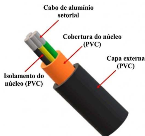
Figura 1: Estrutura de um cabo elétrico
