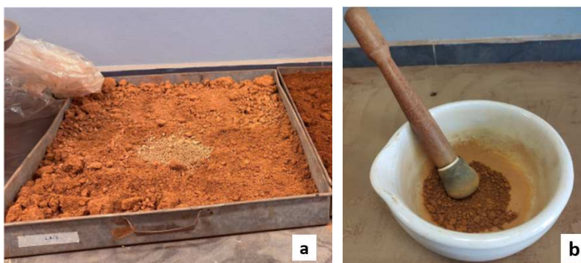
Figura 5: Preparação: (a) Solo em processo de secagem ao ar; (b) Destorroamento com mão de gral e almofariz
