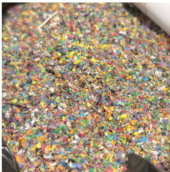
Figura 3: Resíduo plástico triturado dos cabos elétricos
