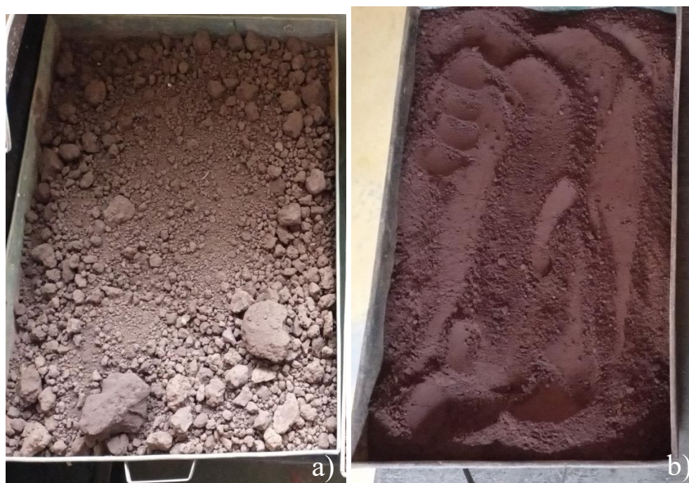
Figura 5: RMFF disposto em bandejas: (a) secagem ao ar e (b) destorroado
