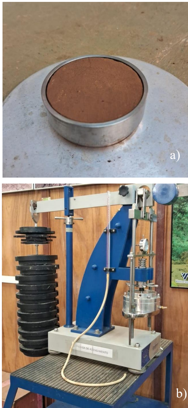
Figura 11: (a) Corpo de prova de RMFF moldado para ensaio oedométrico e (b) Prensa Bishop para ensaio oedométrico
