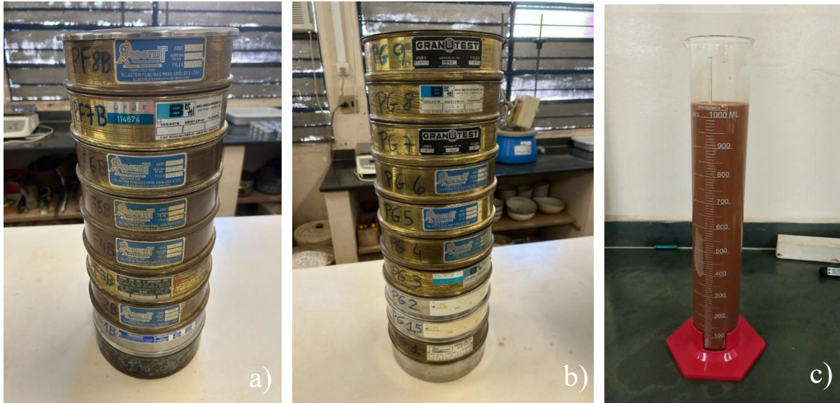
Figura 6: Equipamentos utilizados para: (a) peneiramento fino, (b) peneiramento grosso e (c) sedimentação
