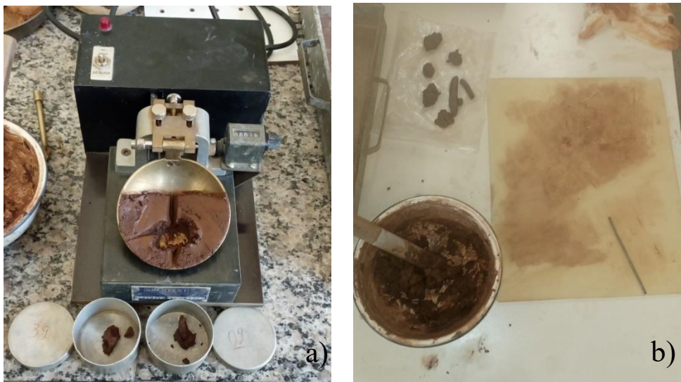
Figura 8: Equipamentos utilizados nos ensaios de: (a) LL e (b) LP
