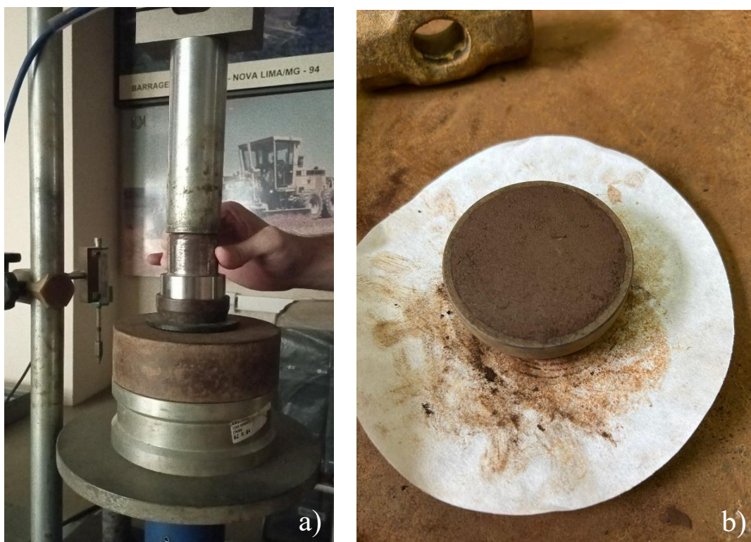
Figura 9: Moldagem do corpo de prova para o ensaio de cisalhamento direto: (a) prensa e (b) corpo de prova de RMFF moldado
