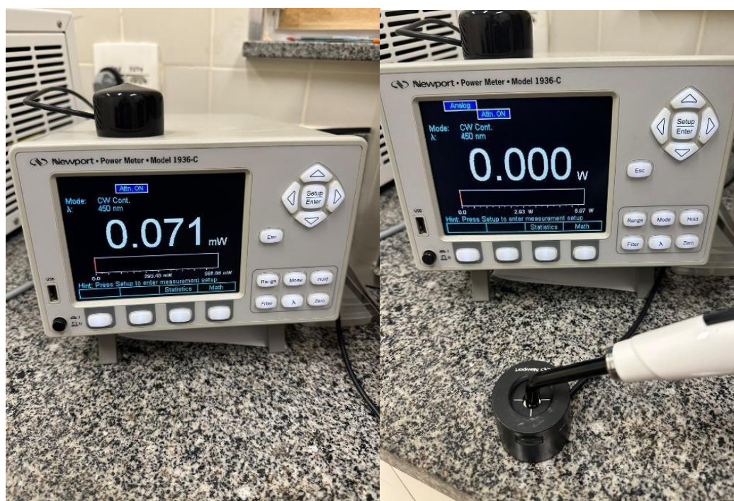
Figura 12 – Ponteira do LED posicionada sobre o espectroradiômetro para verificação da potência (mW)
