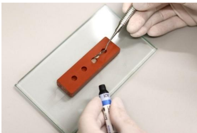
Figura 4 – Confeção das amostras da Resina Filtek Z 350 XT pela técnica incremental
