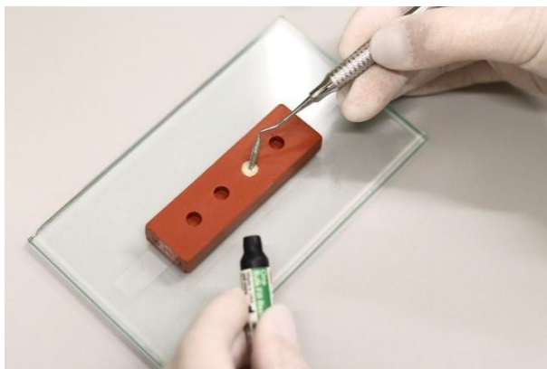
Figura 5 – Confeção das amostras da Resina Filtek One Bulk Fill pela técnica do incremento único
