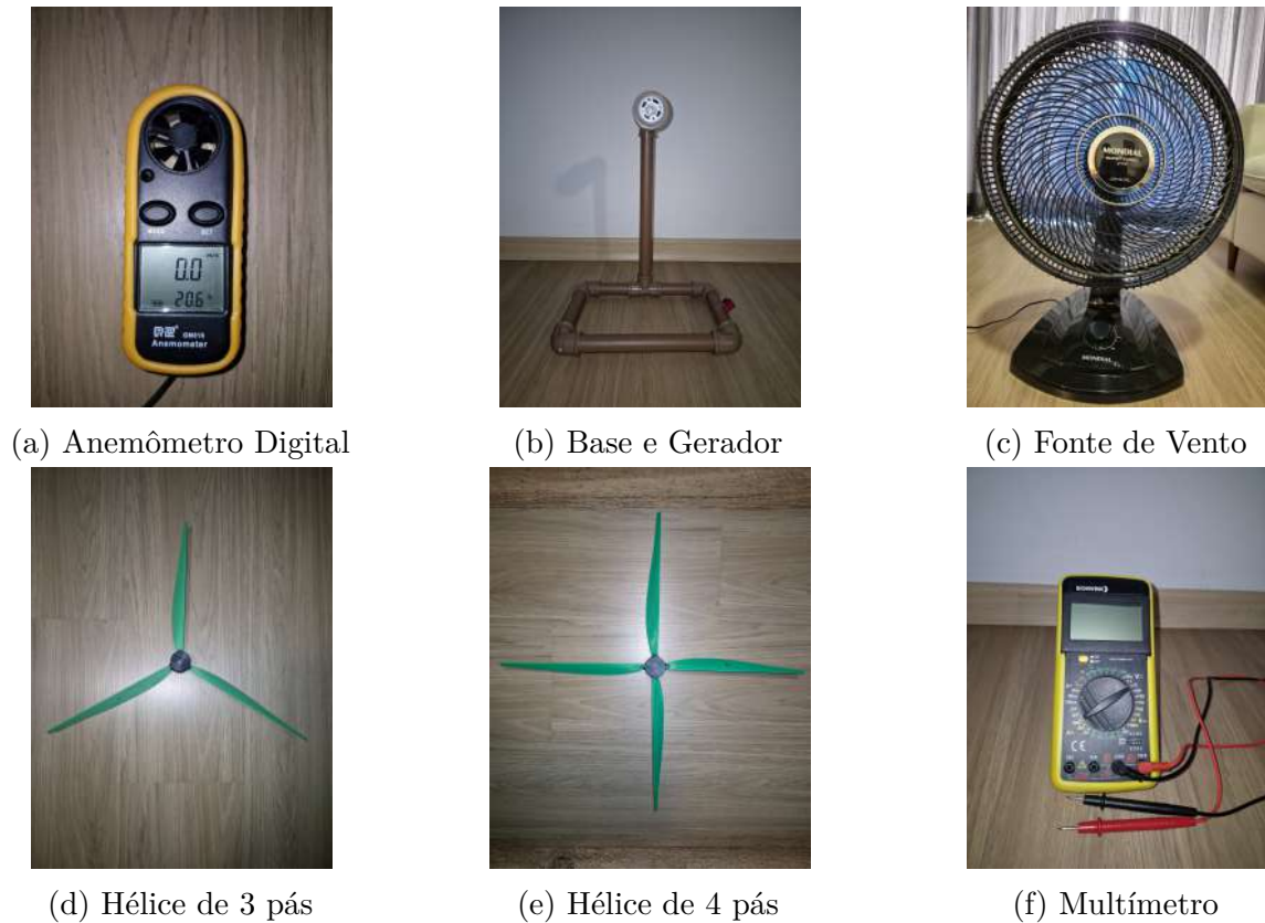
Figura 1 – Materiais e instrumentação utilizados no experimento de bancada.
