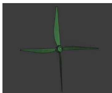
(c) Hélice de 4 pás modelada no FreeCAD
