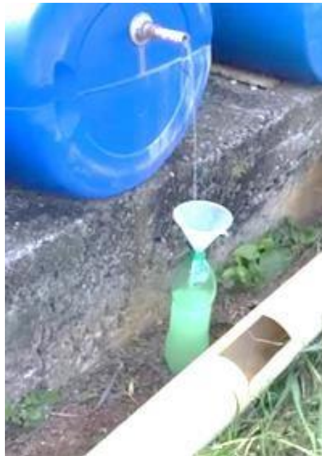
Figura 16 - Procedimento de coleta das amostras de águas residuárias nos SACs
