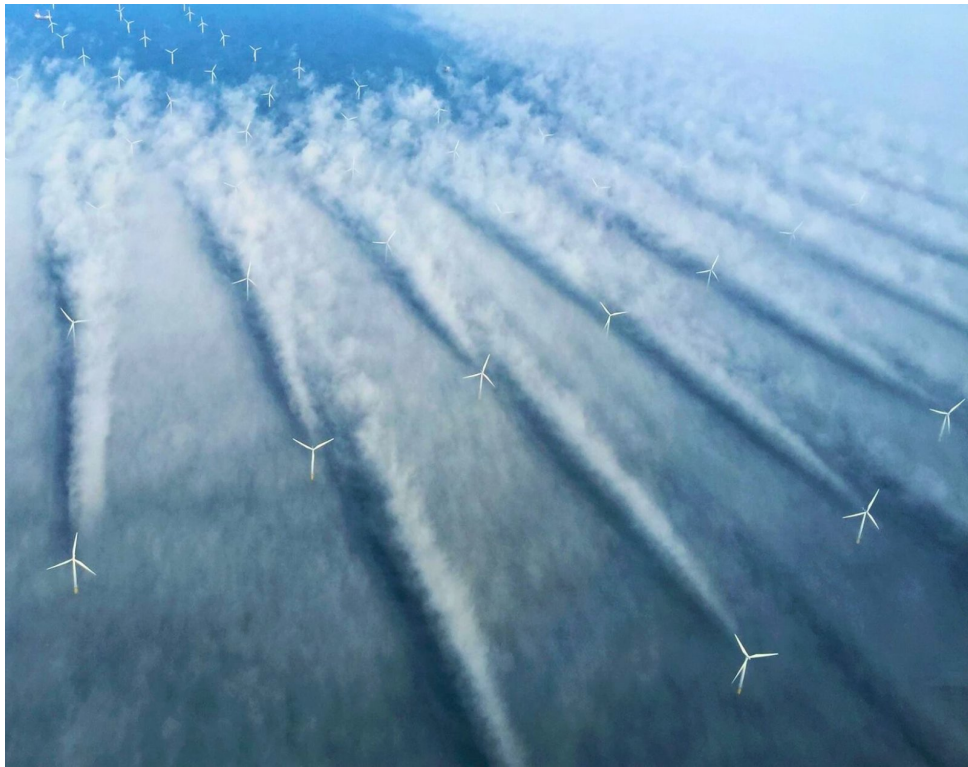
Figura 21 – Fenômeno do wake effect .
