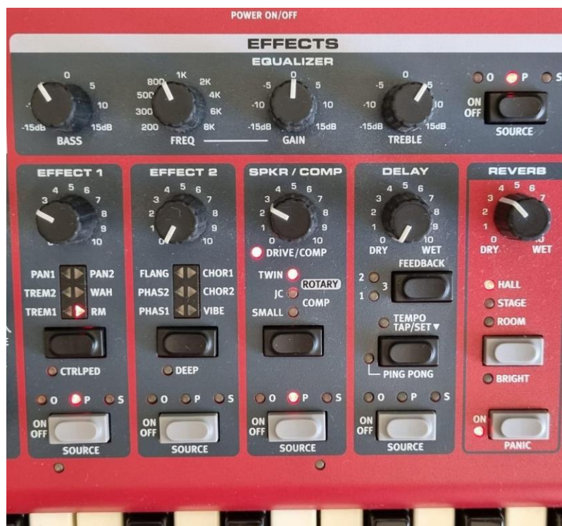
Figura 41 - Imagem do painel de efeitos do Nord Electro 6D com as configurações aproximadas utilizadas na gravação
