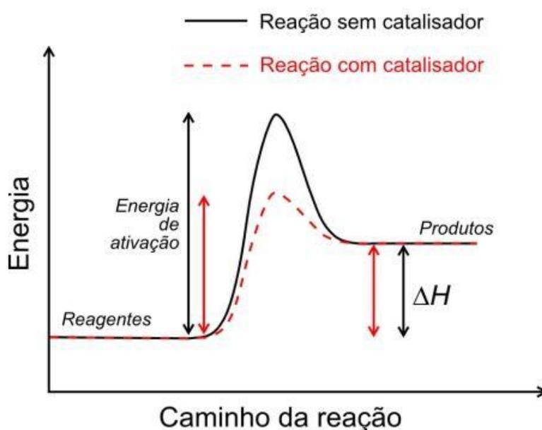
Figura 21: Esquema de uma reação química indicando a energia de ativação com catalisado (curva em vermelho) e sem catalisado (curva em preto).
