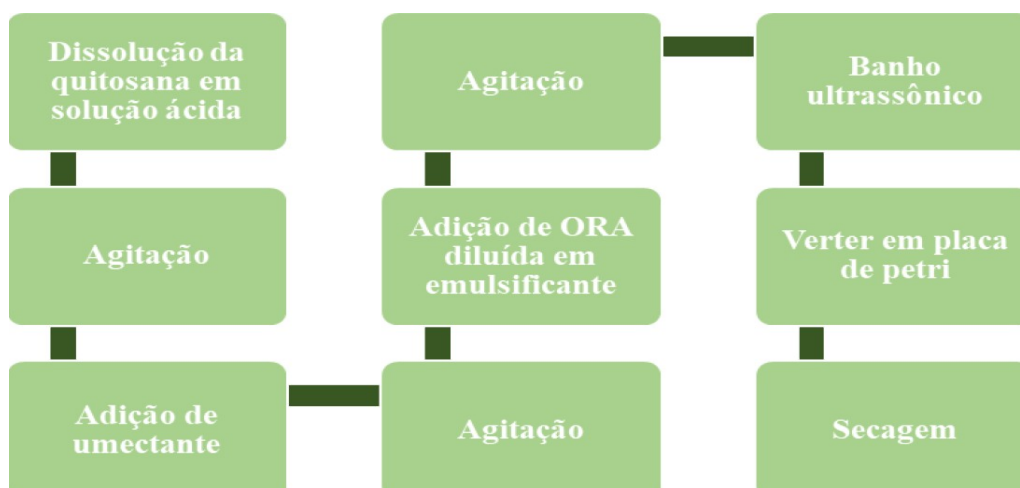
Figura 4: fluxograma do processo de formulação dos filmes.
