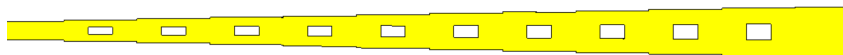
Figura 29 – Projeto do transformador de impedância Klopfenstein particionado com fator de aplicação do fractal de \frac{1}{3} construído no CST Studio Suite .
