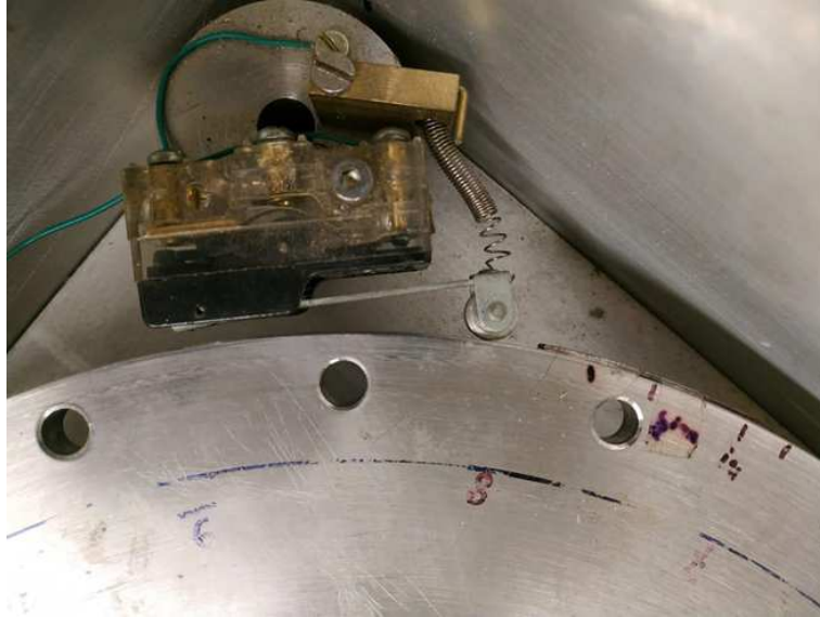
Figura 19 – Foto retirada do contador de voltas.
