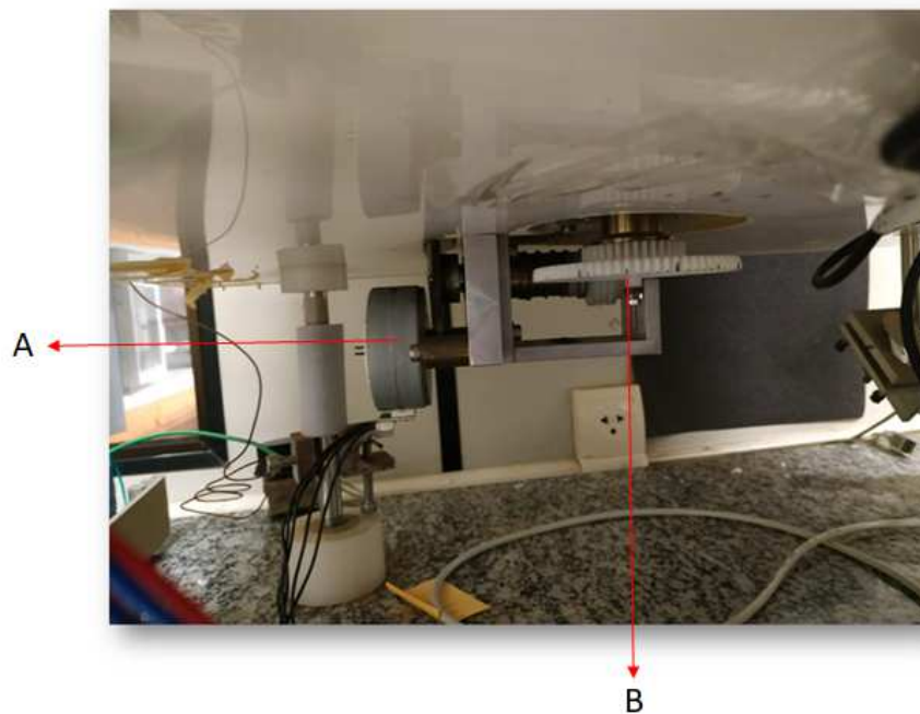
Figura 15 – Foto retirada do motor de passo, onde (A) mostra a posição do motor de passo e (B) representa as engrenagens responsável pelo giro do disco.
