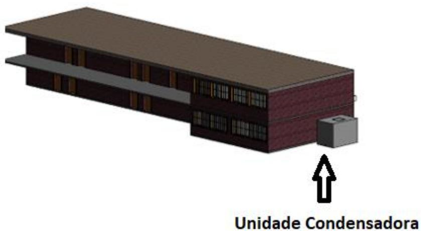
*Figura 14: Layout do posicionamento da unidade condensadora para a alternativa 2 (VRF - centralizado).*
